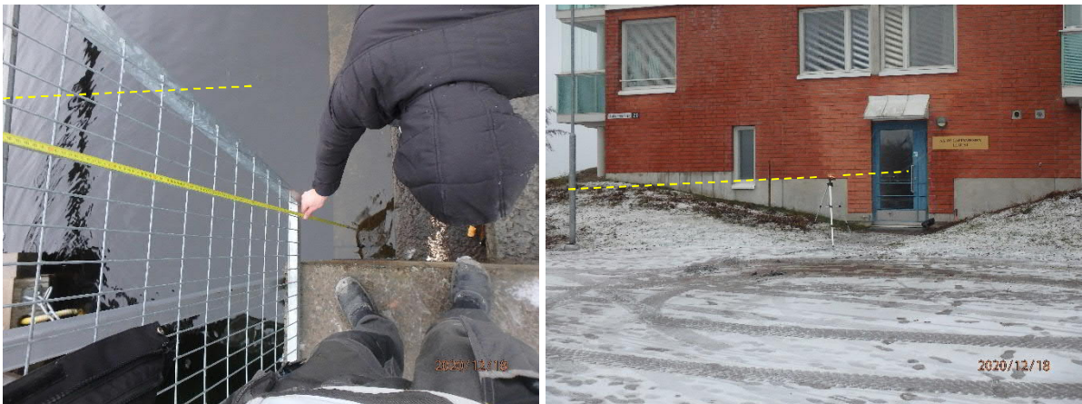
Kuva 8. Näsijärven vedenkorkeus sidottiin kellarikerroksen korkeusmittauksiin 18.12.2020.
